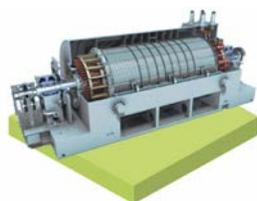
**Турбогенератор** – прямое сочетание турбины с электрическим генератором для преобразования механической энергии в электрическую
